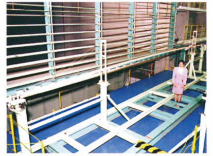
吊橋全体系3次元弾性模型試験
